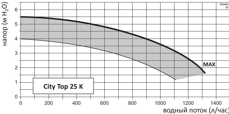
См. также «Настройки циркуляционного насоса» на стр. 43. Кривые MAX, представленные на данных диаграммах, основаны на показателях напора, установленного на фабрике (см. параметр 35 на стр. 36) и уже исключают потери давления при заполнении внутреннего контура котла. Пространство представляет собой область действия насоса в режиме модуляции (см. параметр 33 на стр. 36).
