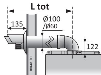
Пример горизонтальной системы «труба в трубе» ( $C_{13}$ )
