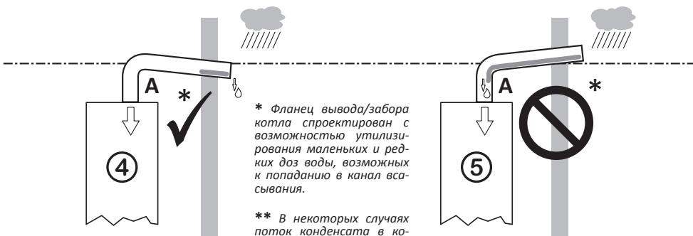
\* Фланец вывода/зaborа котла спроектирован с возможностью утилизации маленьких и редких доз воды, возможных к попаданию в канал всасывания.
