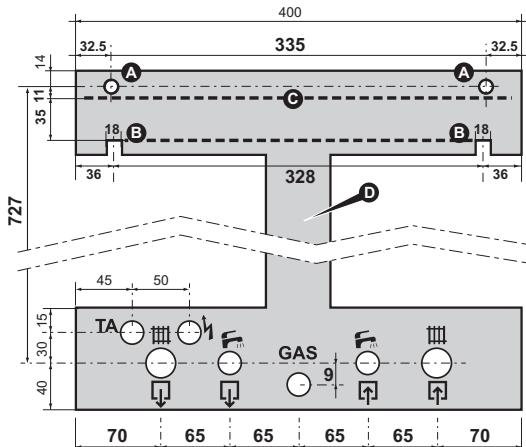
**Примечание:** Как дополнительная опция предлагается специальный металлический шаблон многоразового использования (D на рисунке), облегчающий позиционирование точек крепления (с использованием оригинального Комплекта подсоединения). Если не используется металлический шаблон многоразового использования и / или оригинальный Комплект подсоединения, о позиции гидравлических подключений котла можно прочитать в параграфе «Габаритные и присоединительные размеры» на стр. 15.
