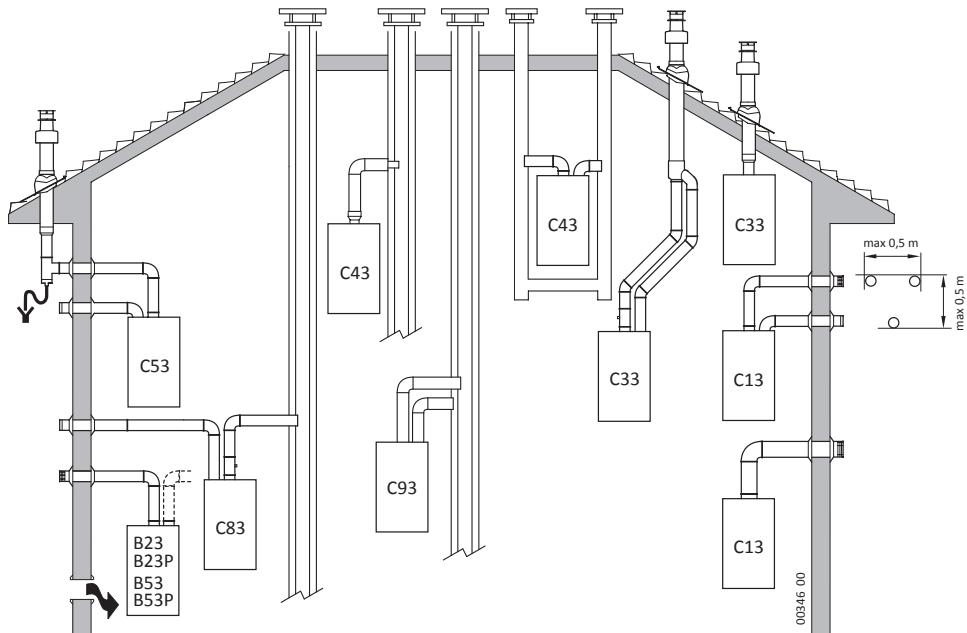
**!** Все элементы канала вывода должны быть реализованы в соответствии с действующими местными законодательными нормами. В обязательном порядке должны использоваться дымоходы устойчивые к температуре, конденсату, механическим напряжениям, а также быть герметичными.
